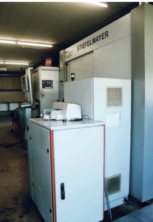
Die erste Diodenlaser-Härteanlage von BR Tec. Alle Fotos: Klinker
