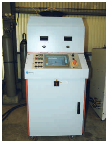
Der 3-kW-Diodenlaser bietet genügend Leistung für das Laserstrahlhärten.
